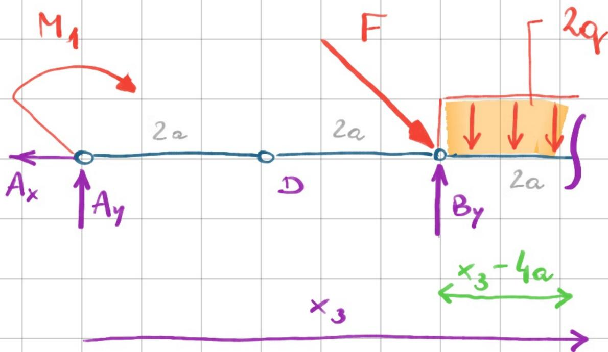
$$Mq^{\text{III}} : M_1 + A_y x_3 - F_1 (x_3 - 4a) + B_y (x_3 - 4a) - \underbrace{q (x_3 - 4a)^2}$$
