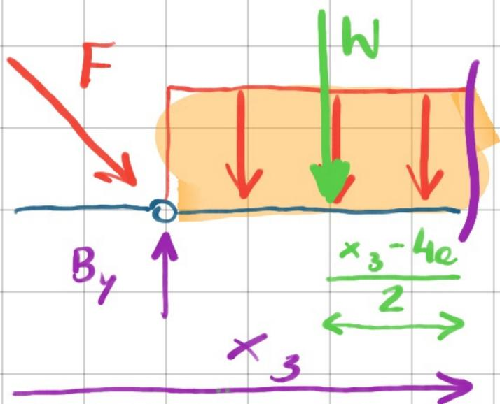
Interesuje nas tylko zamalowany fragment obciążenie ciągłego, do miejsca oznaczonego cięciem
