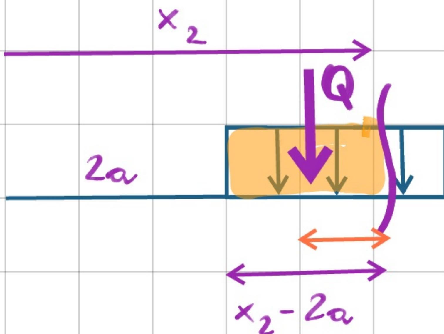
$Q$  - obciążenie zastępujące za obciążenie ciągłe
