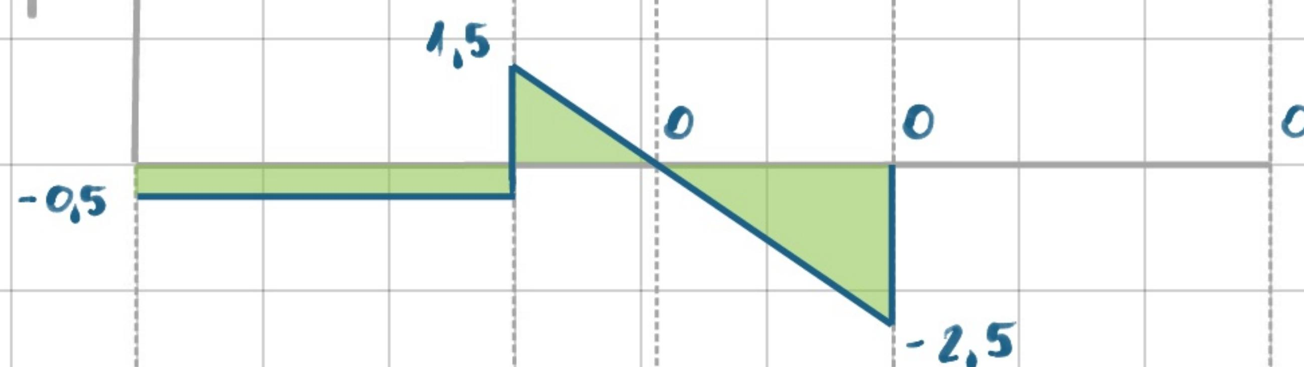
Wykres momentu gnącego rysujemy z osią dodatnią skierowaną w dół. W ten sposób także orientujemy ramiona paraboli dla tej części wykresu, która dotyczy obciążenia ciągłego.
