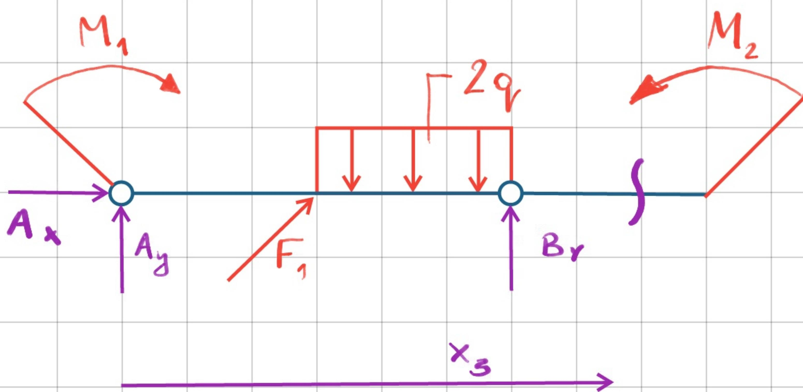
$$Mg^{\text{III}} = M_1 + A_y x_3 + F_{1y} (x_3 - 2a) - 2q \cdot 2a (x_3 - 3a) + B_y (x_3 - 4a)$$
