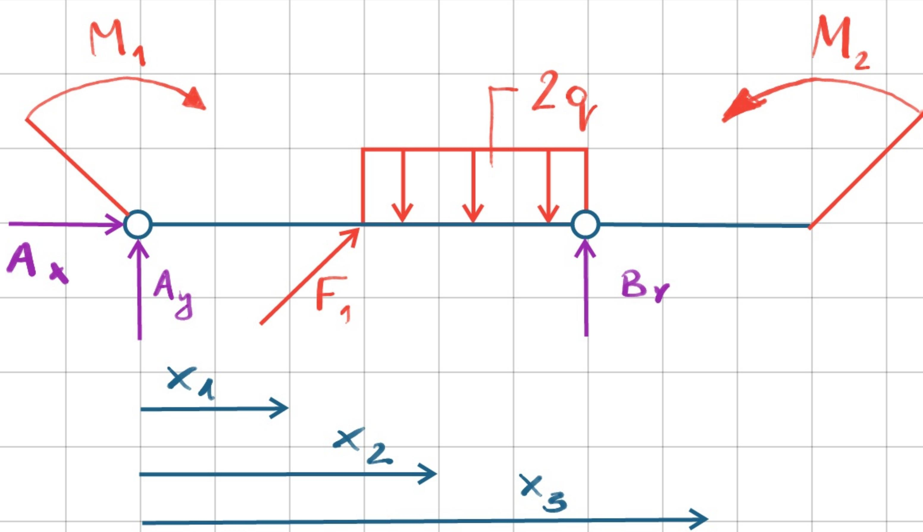
$x_i$  to ramię do wyznaczania momentu zginającego powstającego od poszczególnych sił
