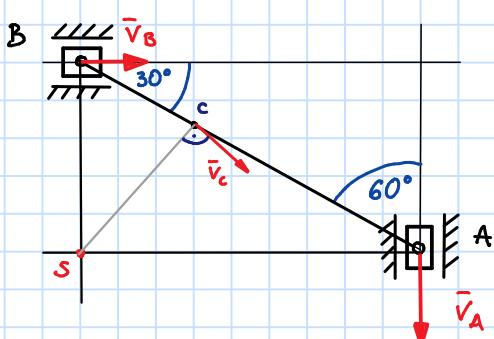
Położenie chwilowego środka obrotu wyznaczono graficznie na przecięciu prostych prostopadłych do wektorów prędkości  $\bar{v}_A$  i  $\bar{v}_B$ . Wektor prędkości  $\bar{v}_C$  jest prostopadły do ramienia wektora  $\bar{CS}$
