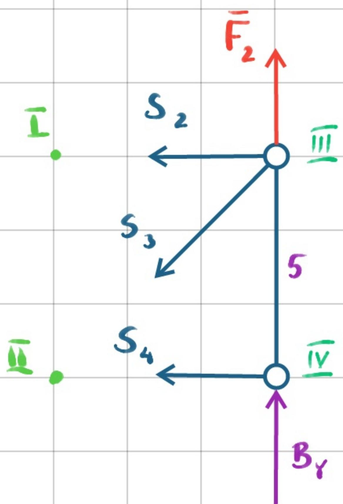
sity w przeciwnych przetach oznamy ze zwrotami od węzłów, jeśli sity wyjdą dodatnie wówczas jest to sita rozciągająca, jeśli ujemna to ścisząca
